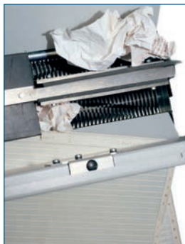
Schneidwellen aus speziell gehärtetem Stahl
