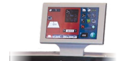
Das Cockpit der DocuFold Pro: Der große farbige Touchscreen für die komplette Steuerung, Programmierung und Jobspeicherverwaltung.
