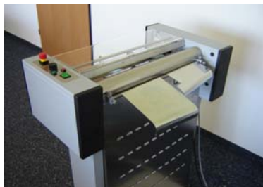
Belegtrennung 2 Nutzen Vortrennstation
